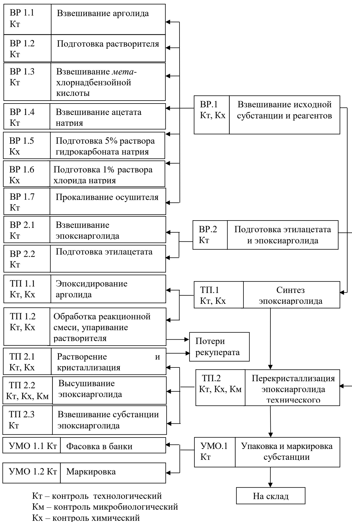
Рисунок 9 – Технологическая схема получения субстанции эпоксирголида
